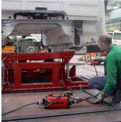
► Empleo de la bancada de cabinas
