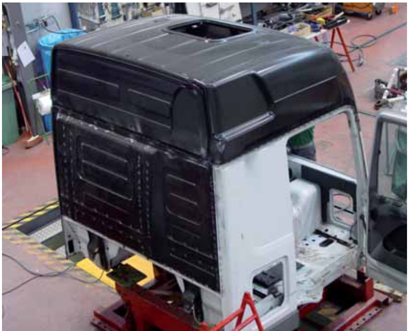
► Cabina reparada y elementos sustituidos
