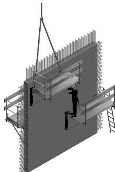
*Montaje de trepado con consola y encofrado movidos conjuntamente*
