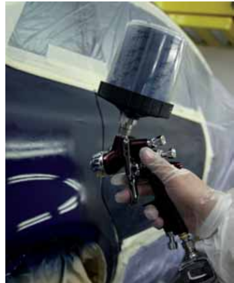
► Aplicación con el sistema PPS, de 3M
