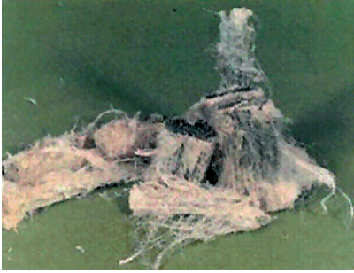
Crisotilo. Roca de Amianto Guía Técnica Exposición a Amianto. INSHT
