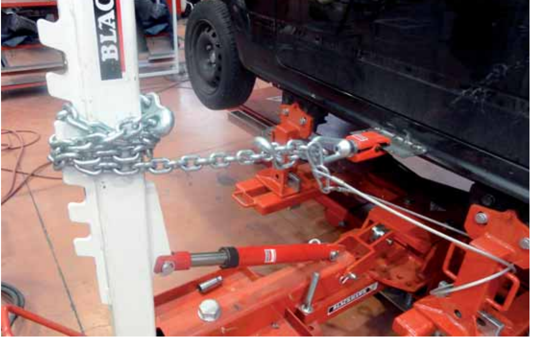
► Conformación del estribo
