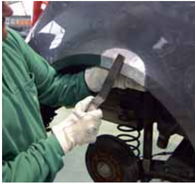
► Reparación con acceso
