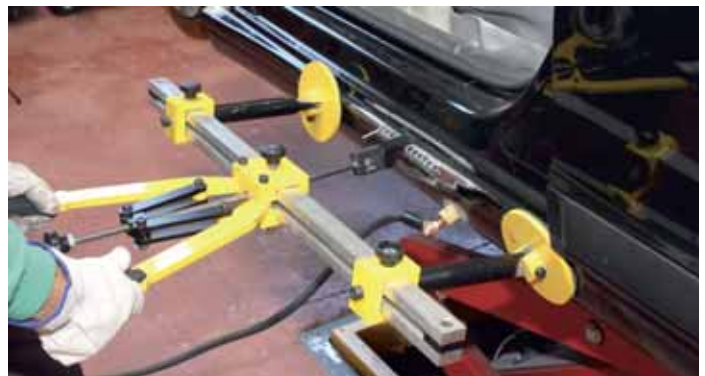
▶ Reparación de un estribo
