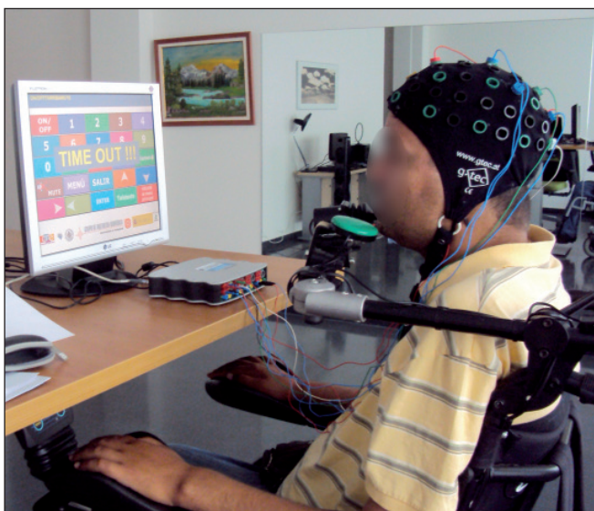
Figura 4. Un usuario del CRE, participante en el estudio, realiza pruebas con la aplicación BCI de control domótico desarrollada durante el presente proyecto. En la fotografía se puede observar el montaje de electrodos necesario para el registro de la actividad EEG, así como el amplificador de señales biomédicas, que destaca por su pequeño tamaño.
