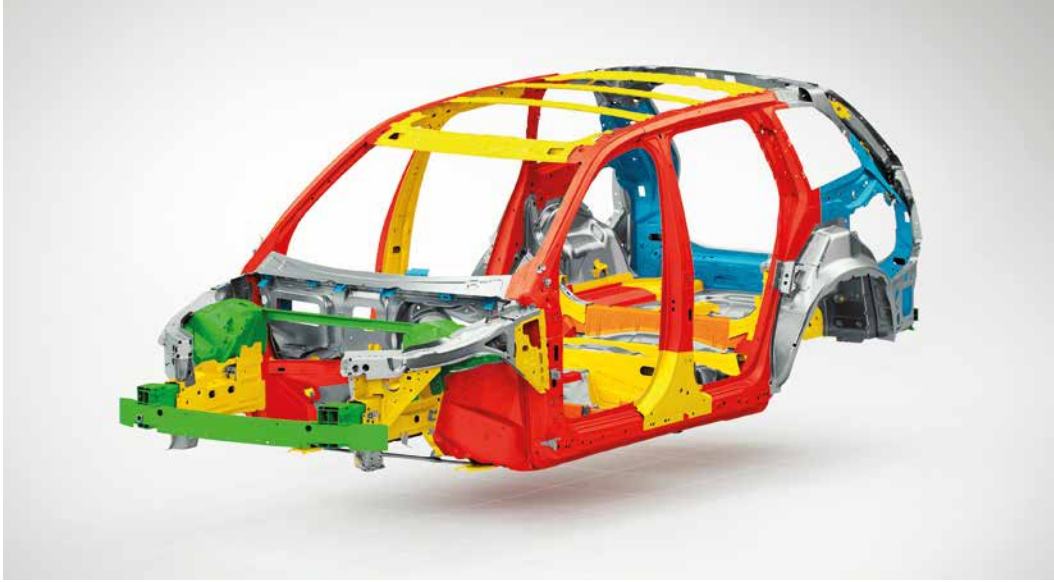
► Aceros de alto límite elástico, en color; en gris, aceros convencionales
