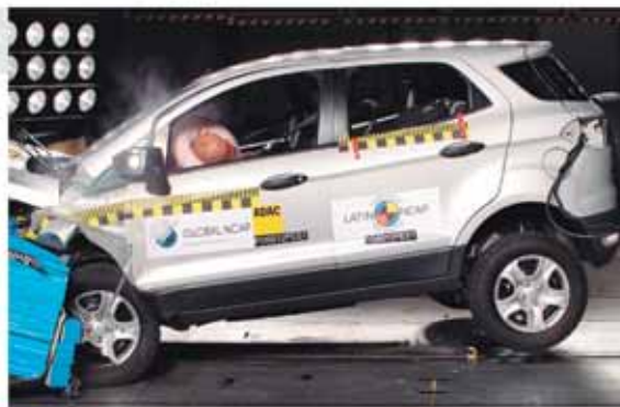
Figura 1: Prueba de Latin NCAP Ford Ecosport con doble airbag
