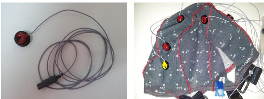
**Figura 2.** (a) Detalle de un electrodo activo para el registro de la señal EEG. (b) Gorro empleado para el registro de la actividad EEG con los electrodos activos.
