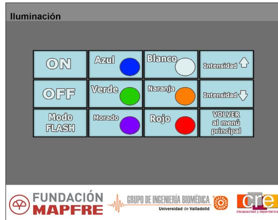
Figura 9. Submenú de control del sistema de iluminación. La aplicación permite que los usuarios puedan controlar tanto el encendido y apagado como el nivel de intensidad y el color de una bombilla.
