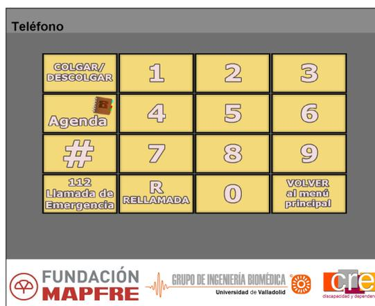
Figura 7. Nuevo submenú de control del teléfono. El usuario puede seleccionar varios comandos de control del mismo: colgar o descolgar, marcar un dígito del 0 al 9, realizar una llamada de emergencia, etc. Además, puede acceder directamente a la agenda telefónica o volver nuevo al menú principal.
