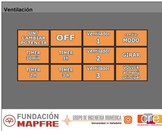
Figura 8. Nueva apariencia del submenú de control del sistema de ventilación. Desde este submenú los usuarios de la aplicación pueden controlar el encendido, apagado, nivel de potencia y el resto de funciones de un ventilador.
