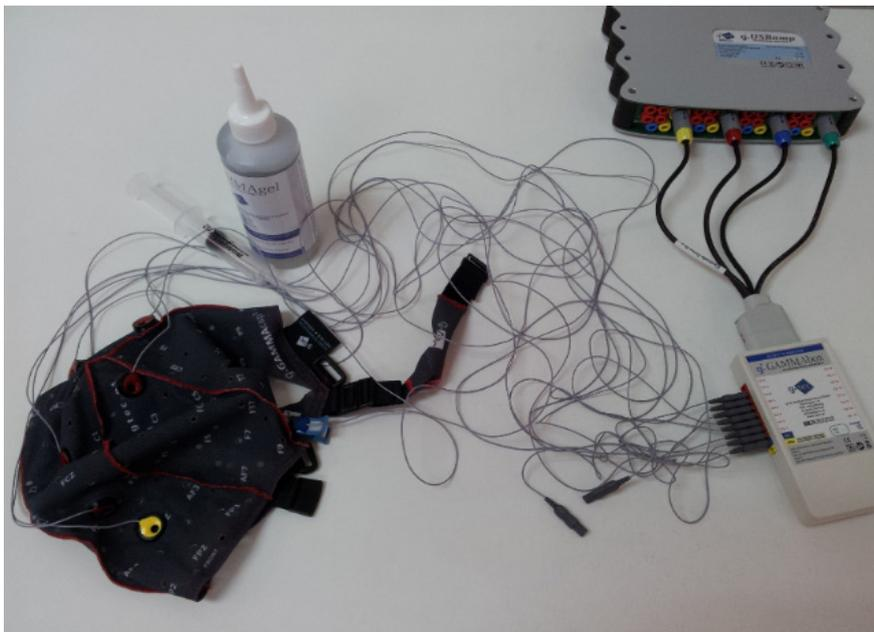
**Figura 1.** Imagen del equipo de registro de la señal EEG del que disponemos: electrodos activos, gorro con la localización estándar de los canales EEG, sistema de alimentación para los electrodos, gel y amplificador de señales biomédicas.
