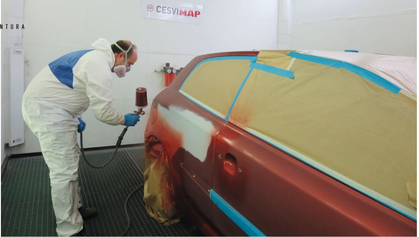
► Aplicación de la base bicapa
