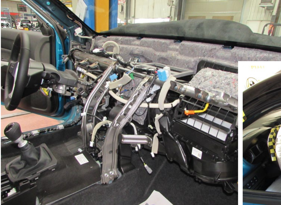
► Desmontaje del salpicadero
