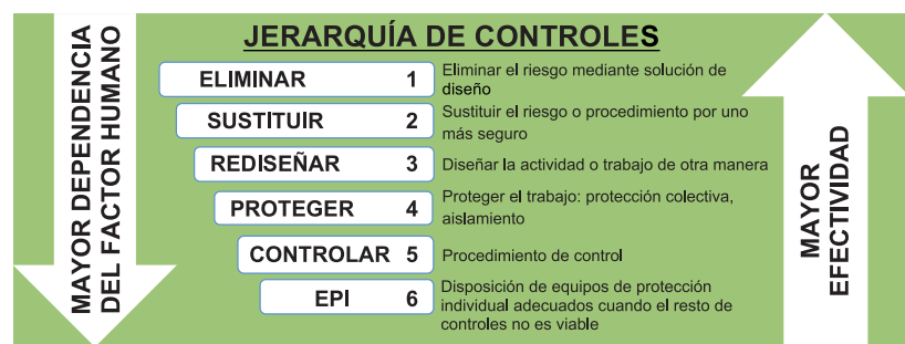
Figura 3 Jerarquía de controles: Prioridades de actuación preventiva en la toma de decisiones en la etapa de diseño.
