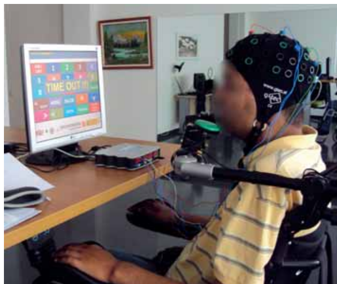
Fig. 1. Un usuario del CRE, participante en el estudio, realiza pruebas con la aplicación BCI doméstica implementada en el presente proyecto. Se puede observar el montaje de electrodos necesario para el registro de la actividad EEG, así como el amplificador de señales biomédicas portátil.
