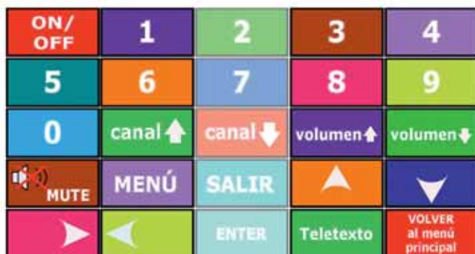
Fig. 4. Submenú de control de la televisión. Este menú está formado por una matriz de 5 x 5 imágenes. El usuario puede seleccionar diferentes acciones: encender o apagar, subir o bajar el volumen, cambiar de canal, acceder al menú de configuración o al teletexto, etc. Esta captura fue realizada durante la intensificación de la tercera columna de la matriz.
