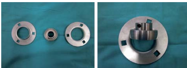
Fig. 2. Rodamiento multidireccional bloqueable.
