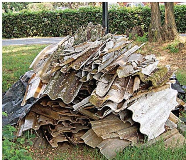
Figura 17. (a) Residuos incontrolados de fibrocemento.
