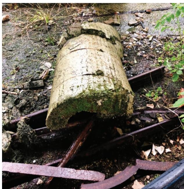
Figura 17. (b) Residuos incontrolados de material usado como calorifugado.
