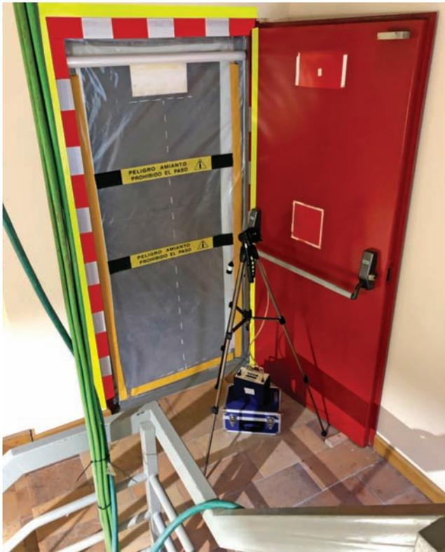
Figura 9. (b) Mediciones de control del aire en el exterior del confinamiento.
