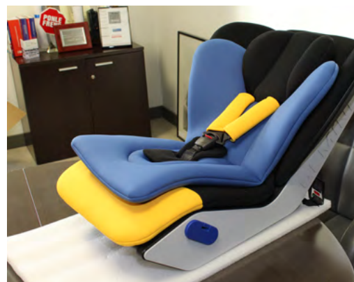
Demostrador de sistema de retención infantil para afectados por la osteogénesis imperfecta
