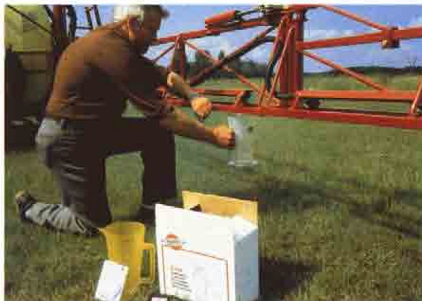
Antes de iniciar el tratamiento hay que realizar la calibración, utilizando agua limpia.
