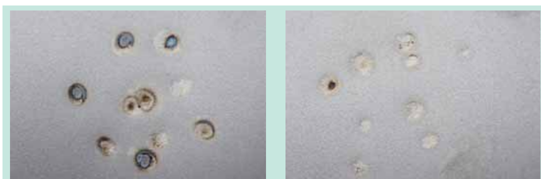
▶ Aplicación incorrecta del electrodo de cobre
