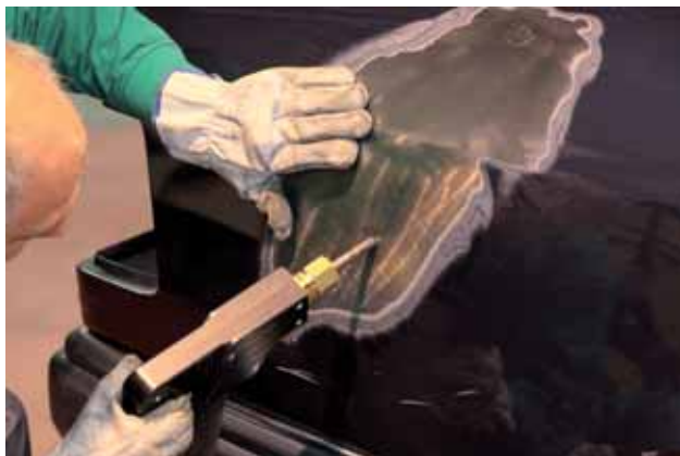
▶ Recogida de chapa mediante electrodo de carbono
