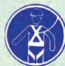
Protección individual obligatoria contra caídas
