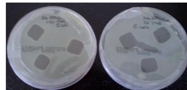
Figura 39. Biopelículas de caseinato de sodio, glicerol y carvacrol (1: 0,25: 0,10) almacenadas durante 14 días a 25 °C y 50 % HR. Inhibición del crecimiento de E. coli .
