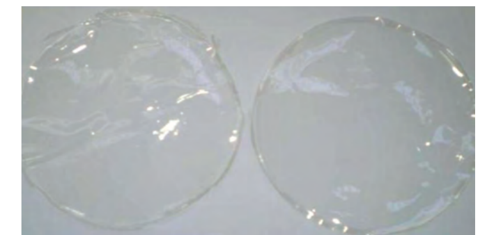
Figura 15. Biopelículas de caseinato de sodio y glicerol (1:0,35) obtenidas sin (izquierda) y con carvacrol (derecha).
