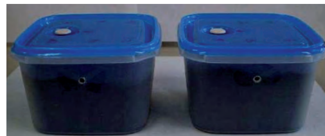
Figura 2. Reactores utilizados para los ensayos de biodegradación.
