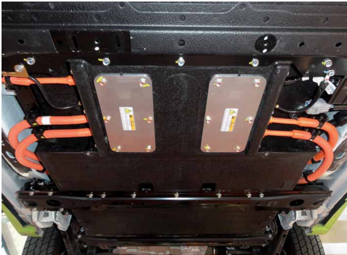
▶ Batería de tracción compuesta de 88 células conectadas en serie
