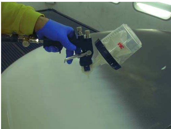
► Aplicación del aparejo h/h sobre cataforesis
