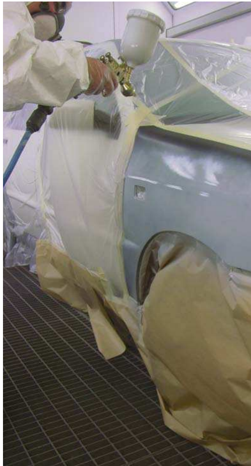
▶ Aplicación del aparejo mediante sistema húmedo sobre húmedo
