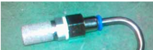
Figura 3. Detalle del inyector del gas de ensayo
