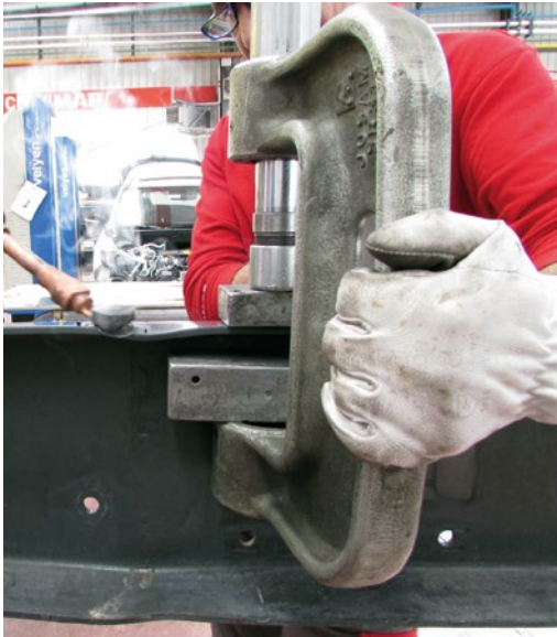
► Reparación de un larguero con aplicación de calor
