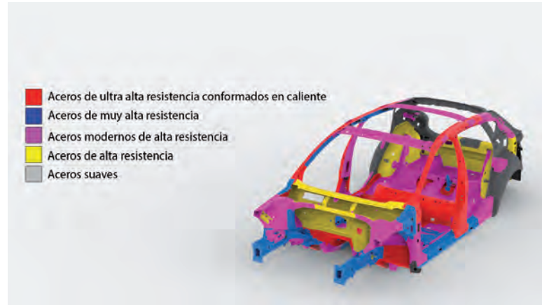
Aceros empleados en la construcción de la carrocería del León 2020
