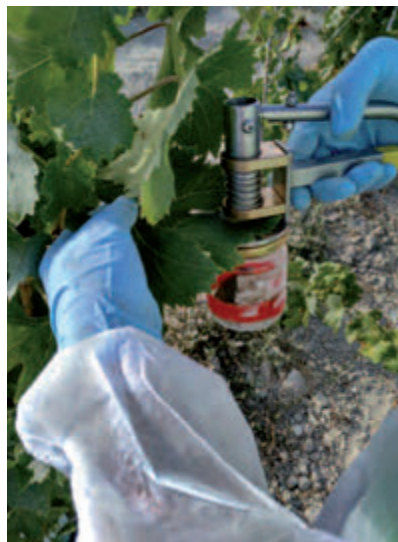
Figura 2 ■ Sacabocados y aspecto de la hoja tras su perforación
