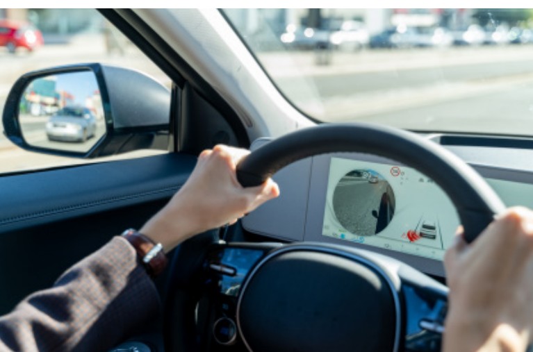
Aviso de obstáculo en el ángulo muerto del conductor en el Hyundai Ioniq 5
