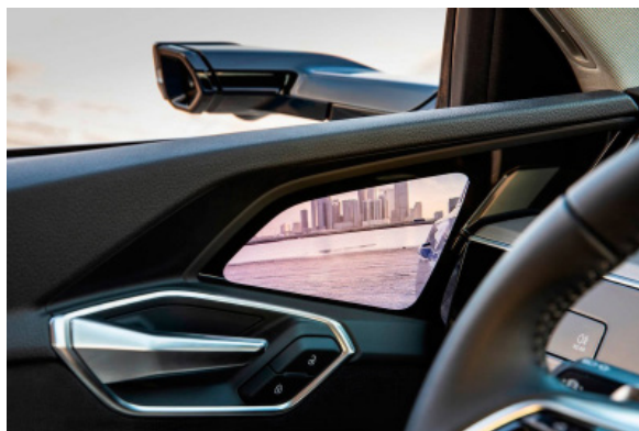
Espejos retrovisores exteriores con cámara, en el Honda-e
