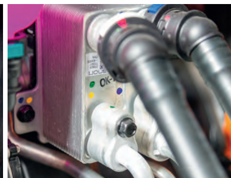
Intercambiador de calor en contacto con el líquido refrigerante
