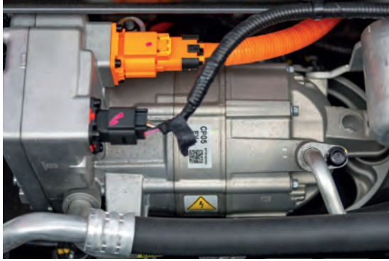
Compresor eléctrico de alta tensión
