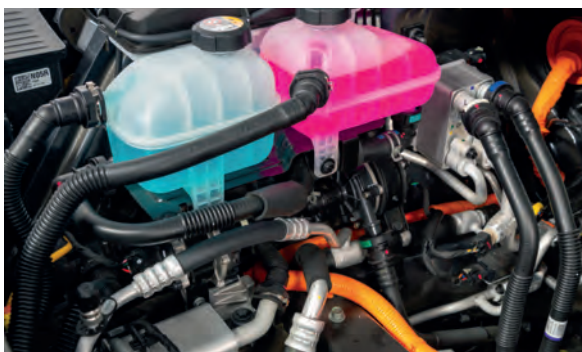
Bombonas de expansión para el sistema de alta tensión y motor eléctrico (depósito de color rosa) y la batería (de color azul).
