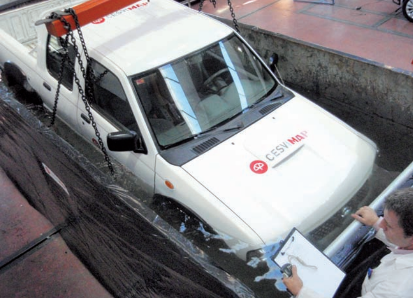
► Inundación dinámica de vehículo pick-up en CESVIMAP
