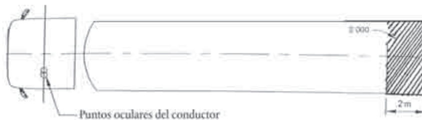
Figura 12: Campo de visión de los dispositivos posteriores de visión indirecta
