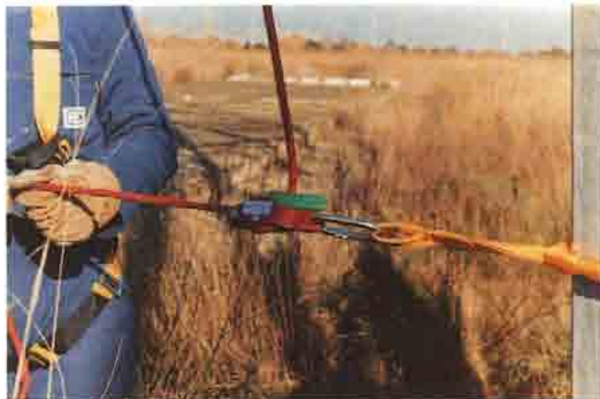
FIGURA 6. Detalle del anclaje al pie de la torre. Regulación de la tensión de la cuerda de seguridad mediante el modulador.
