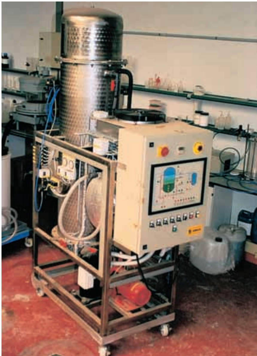
Piloto industrial de evaporación al vacío. Capacidad de evaporación: 400 litros/día.
