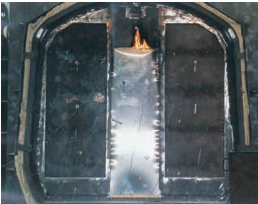
La protección estructural es necesaria, pero suele ser difícil de aplicar a un vehículo ferroviario. En la foto, ensayo realizado por CAF de un tabique de cabina Clase A1. Ya se ha superado el tiempo requerido y las llamas empiezan a pasar al lado «frío». La temperatura del horno, la de la cara «caliente» del tabique, superaba los 850 °C.
