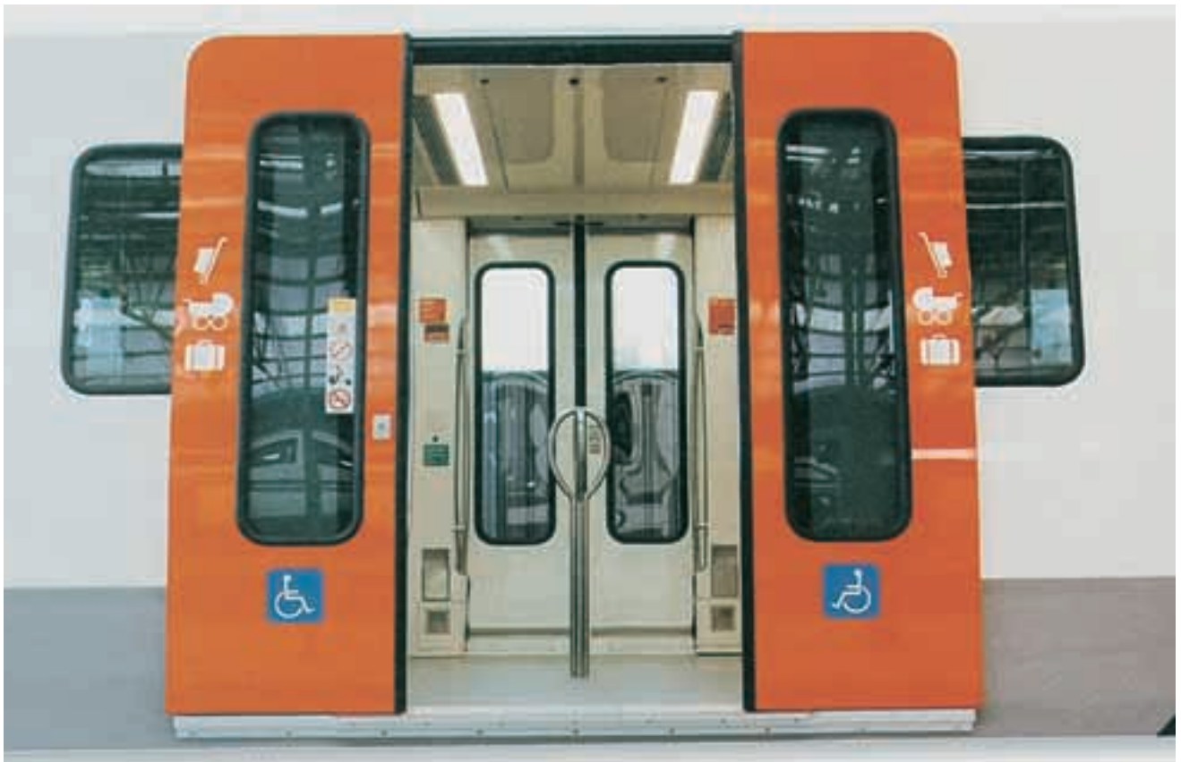
En la actualidad es posible que las personas de movilidad reducida sean usuarias del ferrocarril. En la foto, puertas y plataforma preparadas para el acceso de sillas de ruedas en las unidades de la Serie 213 de FGC.
