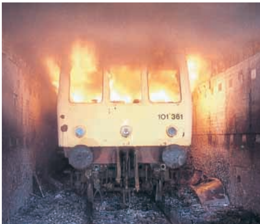
Los ensayos de fuego a gran escala son muy llamativos. El ensayo a escala real suele realizarse en contadas ocasiones, porque es posible conseguir buenos resultados con métodos de ensayo más «modestos».
