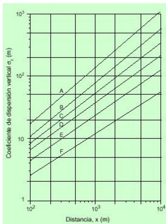
**Fig. 4. Coeficiente de dispersión vertical  $\sigma_z$ , según distancia.**
