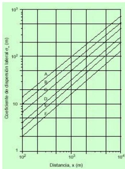
**Fig. 3. Coeficiente de dispersión lateral  $\sigma_y$ , según distancia**
