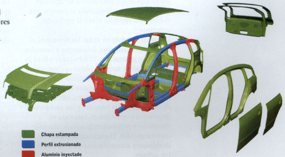
Composición de la carrocería del Audi A2
