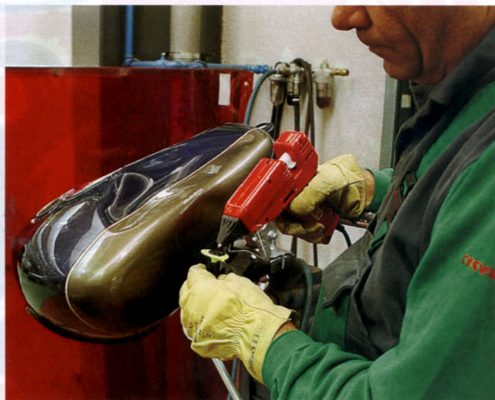
Aplicación del adhesivo sobre la ventosa
