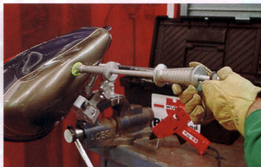
Estirado con el martillo de inercia
