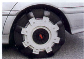
Montaje de las cadenas de palas
