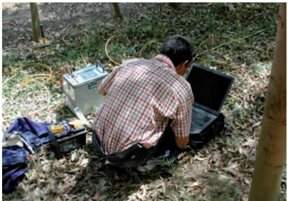
Tomografía eléctrica para conocer la distribución de materiales en profundidad y el nivel freático.
