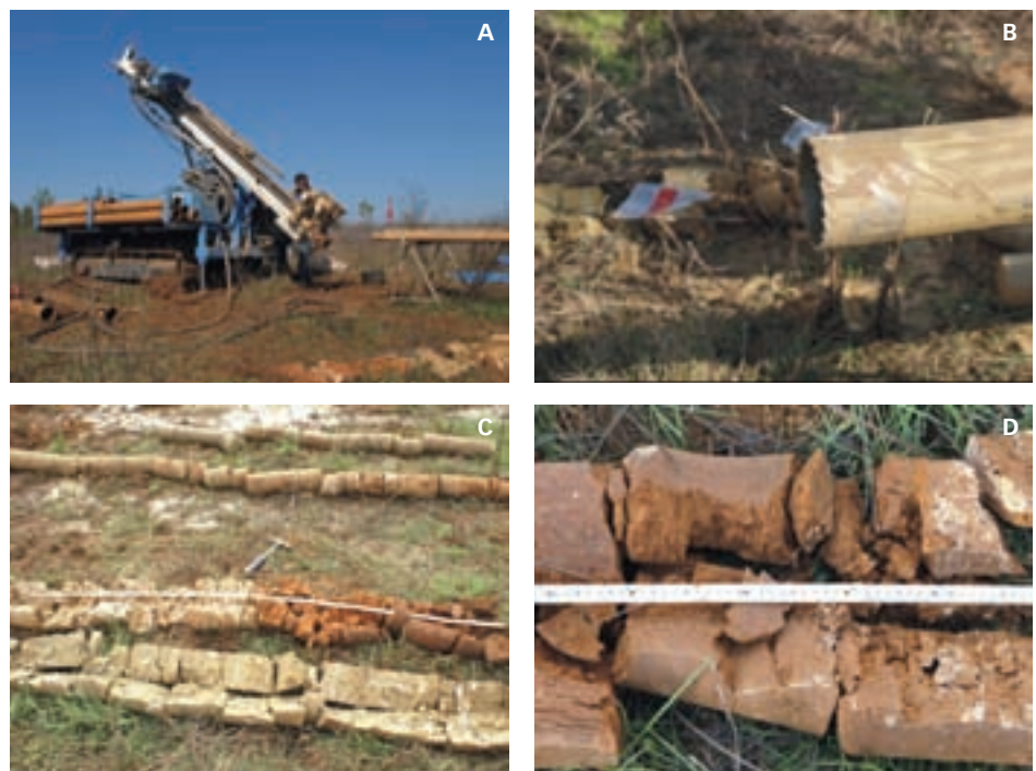
Figura 2. a) Perforación de los sondeos; b) tubería ciega para entubar los sondeos; c) testigos de los sondeos; d) detalle de uno de los testigos.
