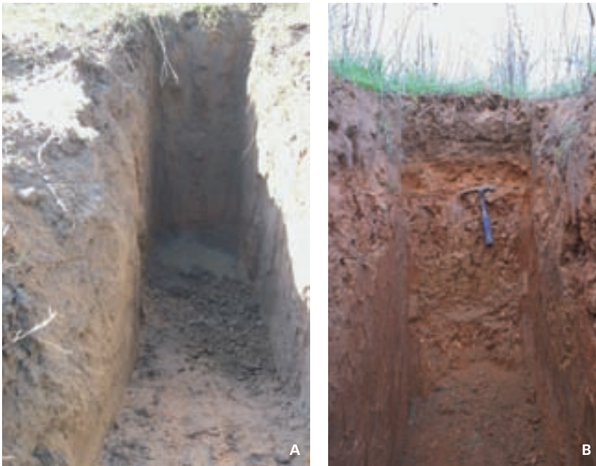
Figura 3. Calicatas en la parcela de experimentación de la PECC. a) Perfil 1 ( Oxyaquic Xerofluvents ); b) Perfil 2 ( Calcic Haploxeralf ).
