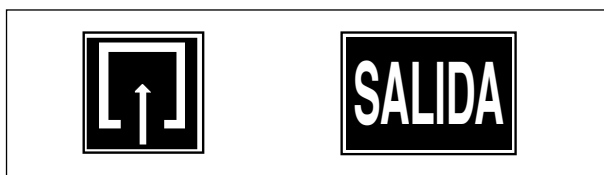
Figura 3. Señalización de salidas habituales según norma UNE 23034
