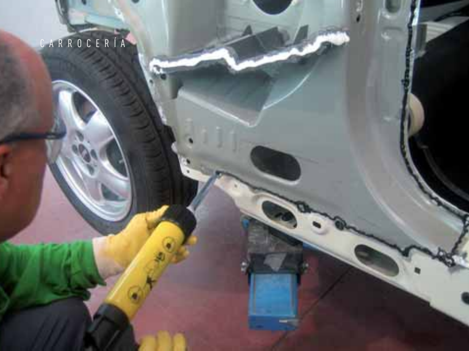
► Aplicación del adhesivo
