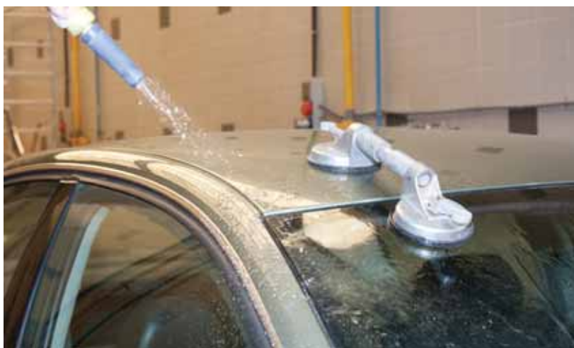
► Prueba de estanqueidad
