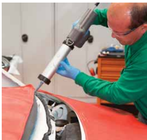
► Aplicación de adhesivo sobre los restos de adhesivo
