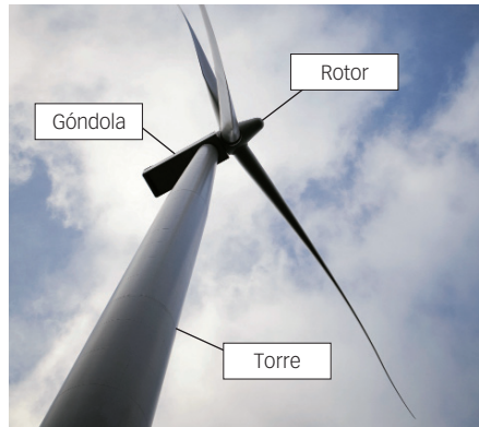
Figura 1. Componentes principales del aerogenerador.
