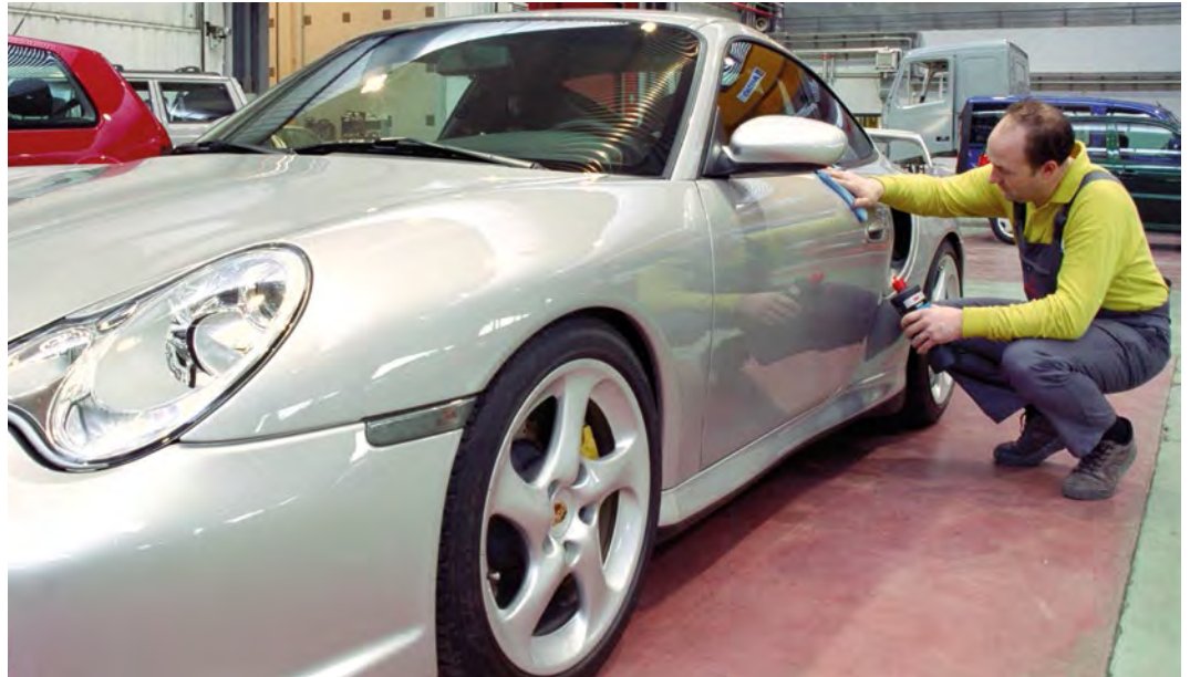
► Examen del nivel de daño
