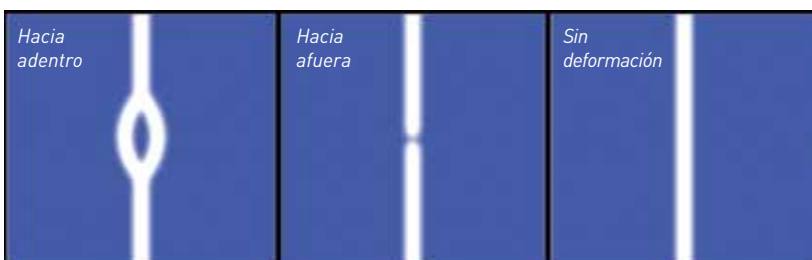
► El reflejo de la luz sobre la pieza delata la deformación de la chapa
