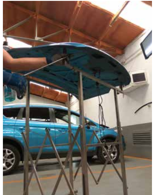
► Reparación mediante varillas
