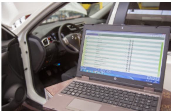
Diagnóstico de un vehículo a través del OBD
