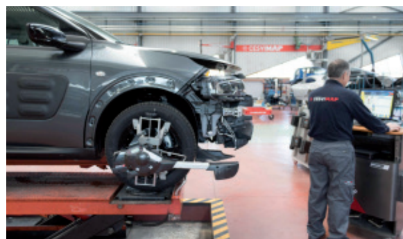
Alineación de la geometría de la dirección en un pantógrafo
