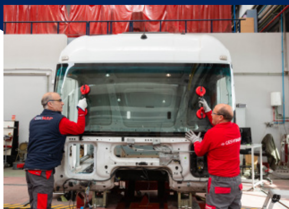
Sustitución de una luna parabrisas
