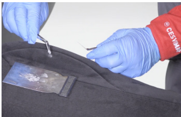
Rotura de un asiento de tejido, tipo velour
