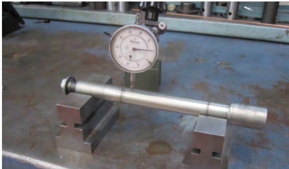
Control dimensional del eje de la rueda delantera
