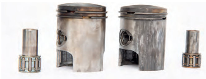
Comparativa: pistones con y sin daños en motores de 2 tiempos
