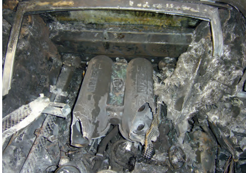
Compartimento motor de un vehículo incendiado
