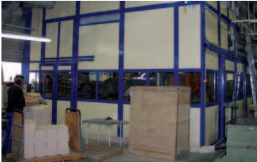
Figura 3: El cierre de los equipos es una de las soluciones más corrientes para la reducción del ruido.
